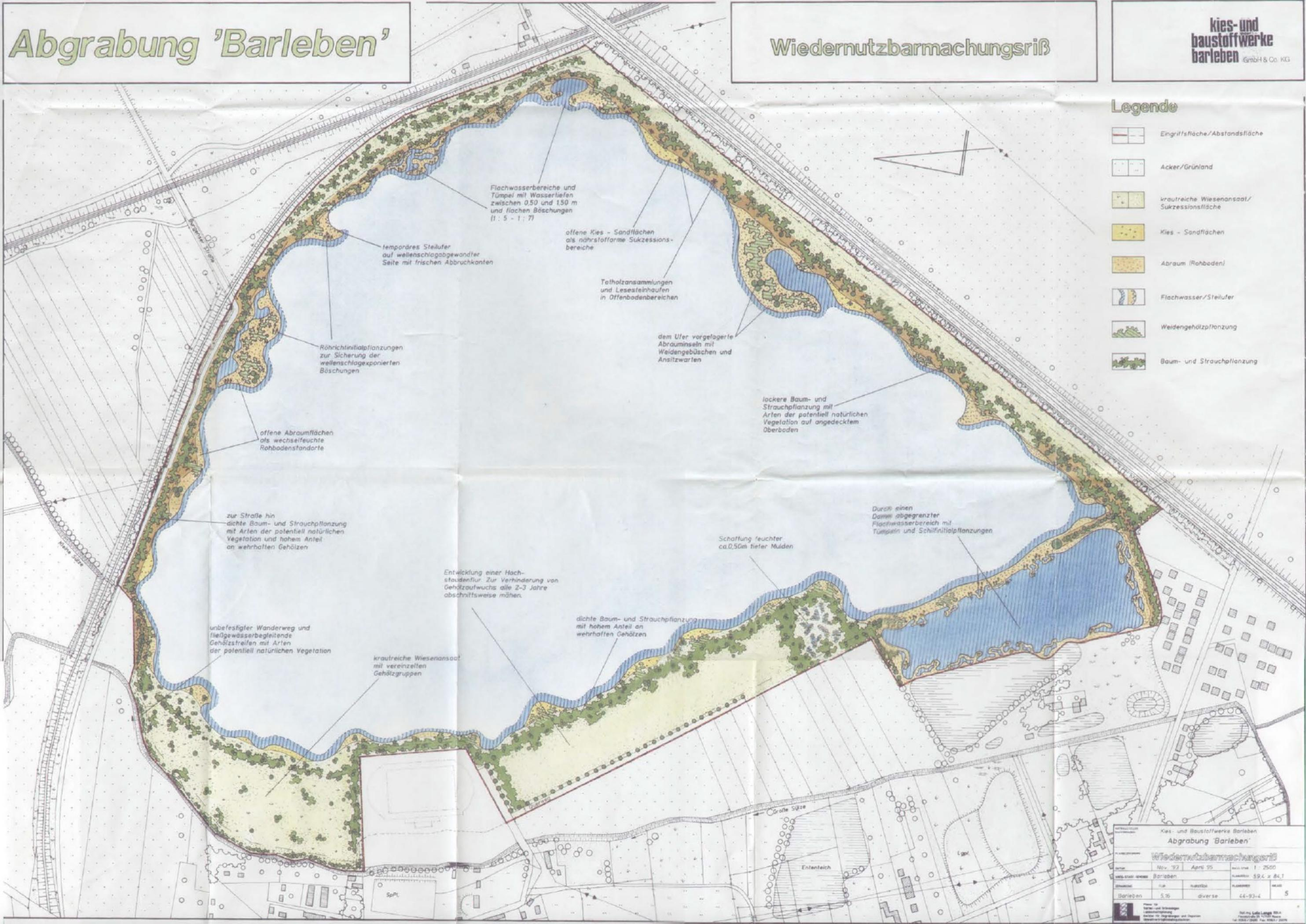
Flachwasserbereiche und Tümpel mit Wasserläufen zwischen 0,50 und 1,50 m und flachen Böschungen (1 : 5 - 1 : 7)
