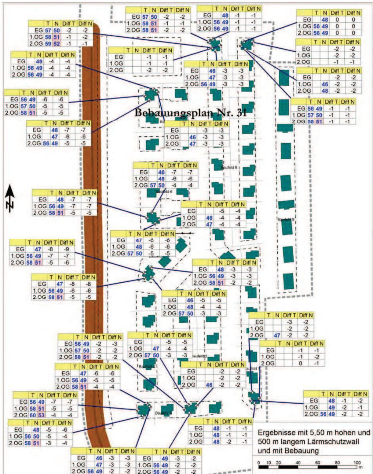
Abbildung 27: Szenario mit Bebauung im Plangebiet - Ergebnisse als Pegeltabellen mit 500 m langem und 5,50 m hohem Wall sowie Pegelminderungen im Vergleich zur Situation ohne Wall
